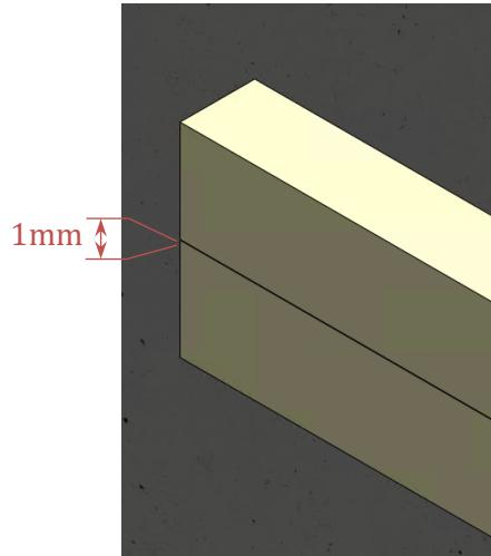
Glisser la tôle dans la fente jusqu'à la position prévue contre le bardage
